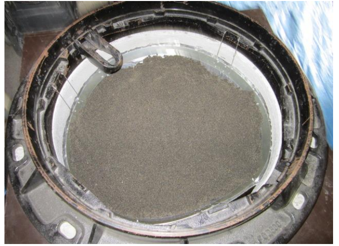
② 断熱シートに40kgの砂を入れた破壊試験
