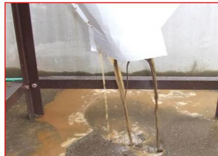
③砂ゴミが排出されるとシート先端部は再び閉口して断熱を継続
