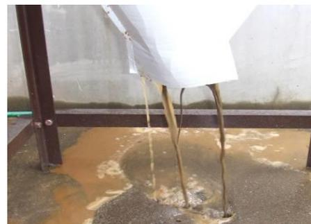
③砂ゴミが排出されるとシート先端部は再び閉口して断熱を継続
